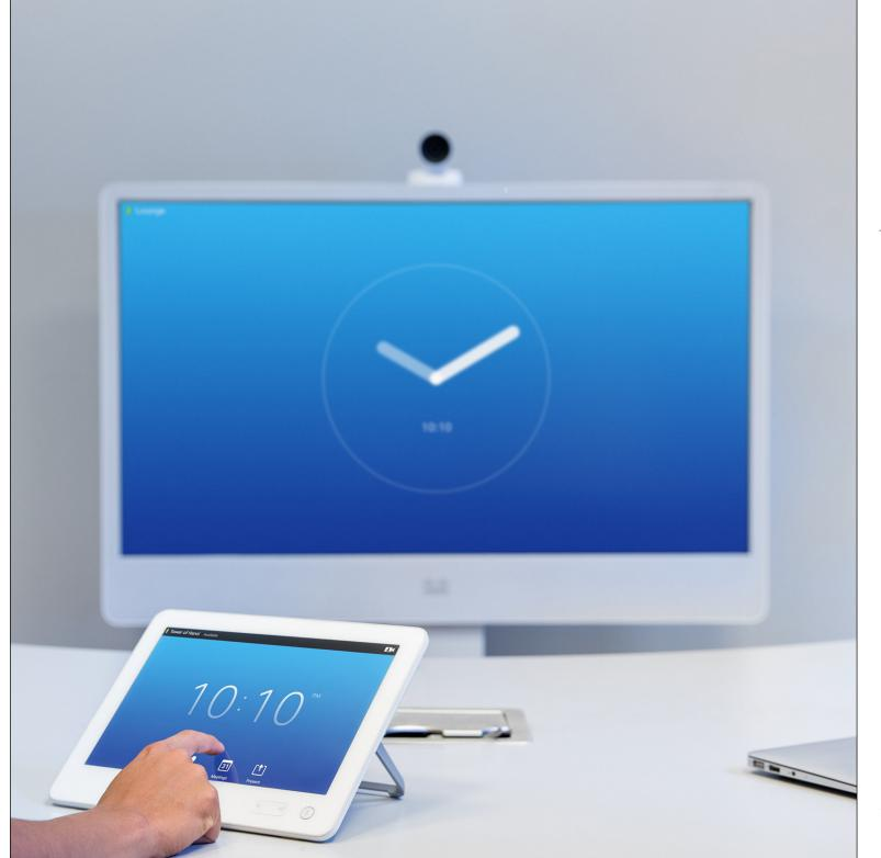
Die Videoendgeräte, deren Nutzung in diesem Handbuch beschrieben wird, können über den Touch-Controller oder die Web-Schnittstelle konfiguriert werden. Für den Zugriff auf alle konfigurierbaren Parameter müssen Sie die Web-Schnittstelle verwenden. Der Touch-Controller bietet nur Zugriff auf bestimmte Parameter.
