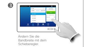
Die Bandbreite gibt an, wie stark der Anruf das Netzwerk beansprucht, und wird in kbit/s (Kilobit pro Sekunde) gemessen.
