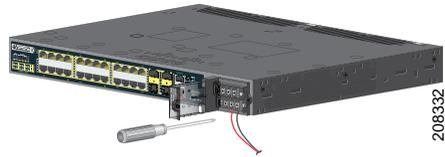
**Étape 4** Environ 45 secondes après sa mise sous tension, le commutateur lance l'autotest à la mise sous tension (POST), qui peut durer jusqu'à 5 minutes.
