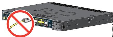
**Étape 2** Lors de l'exécution d'Express Setup, le commutateur agit en tant que serveur DHCP. Si votre PC dispose d'une adresse IP statique, configurez temporairement vos paramètres PC afin d'utiliser DHCP.
