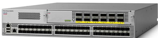
El switch Cisco Nexus 93128TX es un switch de 3 RU que admite 1,28 Tbps en 96 puertos fijos de 1/10 G BASE-T y 8 puertos fijos factor de forma pequeño cuádruple enchufable (QSFP) de 40 Gbps (Figura 2). Los puertos de 40 Gbps se proporcionan en un módulo uplink que el usuario puede reemplazar o dar mantenimiento. El módulo uplink es el mismo para los dos switches. Si se utiliza con Cisco Nexus 93128TX, hay disponibles 8 de los 12 puertos QSFP+ de 40 Gbps.
