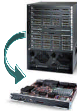
Barres croisées multiprotocole 720 Gbits/s, par Supervisor
