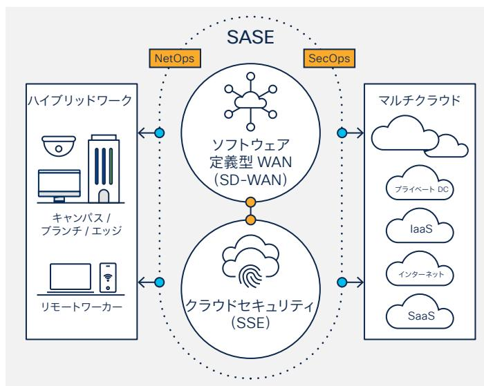
図 4. ネットワークおよびセキュリティの技術と運用を統合することで、安全性の高い新たな接続モデルであるセキュア アクセス サービスエッジを実現
