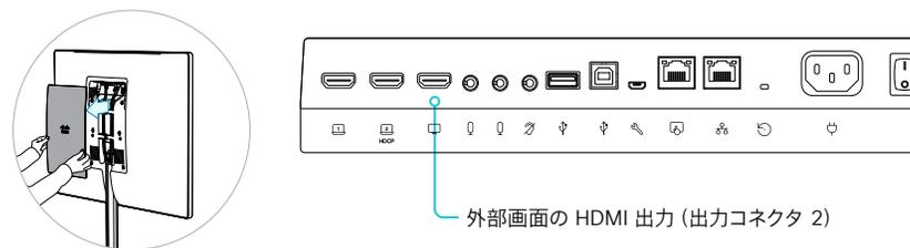
コネクタ パネルおよび電源スイッチを使用するには、背面のカバーを取り外します。
