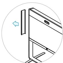
これらのデバイスのコネクタパネルおよび電源スイッチを扱うには、左側のカバーを取り外します。カバーはマグネットで固定されています。
