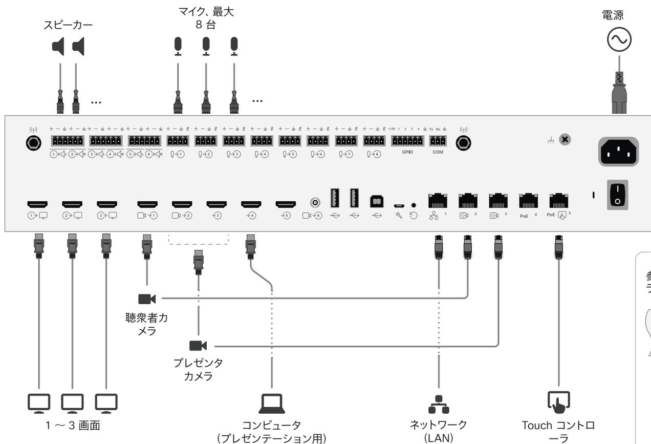
参加者のカメラが Cisco TelePresence SpeakerTrack 60 カメラの場合、2 つの HDMI 入力を使用されます。
