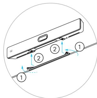
まず、取り付けバーの両側にあるロックハンドルを引いて、デバイスのロックを解除します (1)。次に、デバイスをゆっくりと手前に引き、取り付けバー (2) から持ち上げて、コネクタパネルにアクセスできるようにします。
