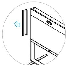
デバイスの左側のカバーを取り外して、コーデックコネクタパネルにアクセスします。カバーはマグネットで留められています。
