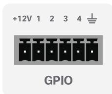
4 つの GPIO のピンのモードは個別に設定できます。アクションのトリガー (入力) またはデバイスのステータスのレポート (出力) を行うようにピンを設定できます。例:
