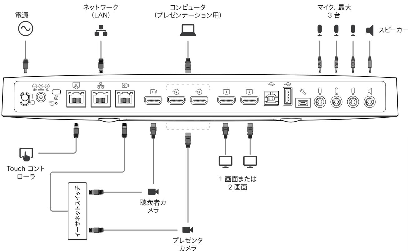
参加者のカメラが Cisco TelePresence SpeakerTrack 60 カメラの場合、2 つの HDMI 入力を使用されます。
