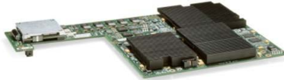
그림 4. CEF720 클래스 인터페이스 모듈에 사용할 수 있는 옵션형 현장 업그레이드 가능 모듈
