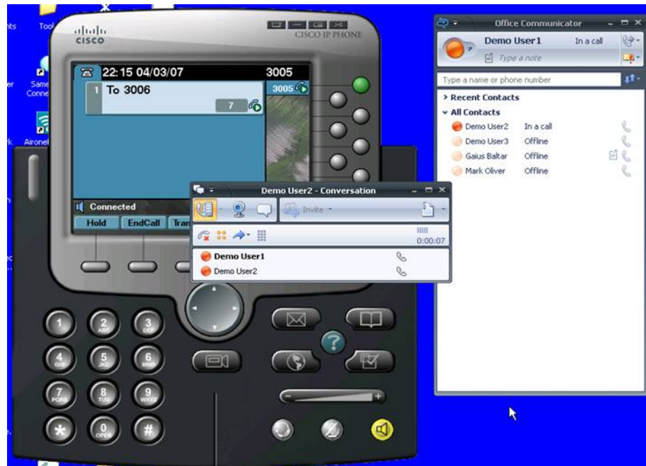
圖 6. 在 Microsoft Office Communicator 2007 中，Cisco Unified IP Phone 臨場狀態從「有空」改變「通話中」
