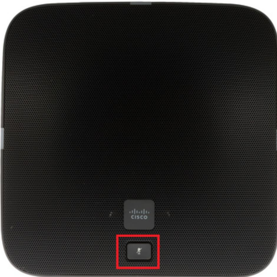
Schritt 3: Halten Sie die MIC-Taste gedrückt, und schalten Sie das Telefon ein (schließen Sie das Ethernet-Kabel oder das Netzteil an). Wenn die LEDs auf der linken, rechten und der Rückseite des Telefons von grün in rot geändert werden, lassen Sie die MIC-Taste los, wie im Bild gezeigt.
