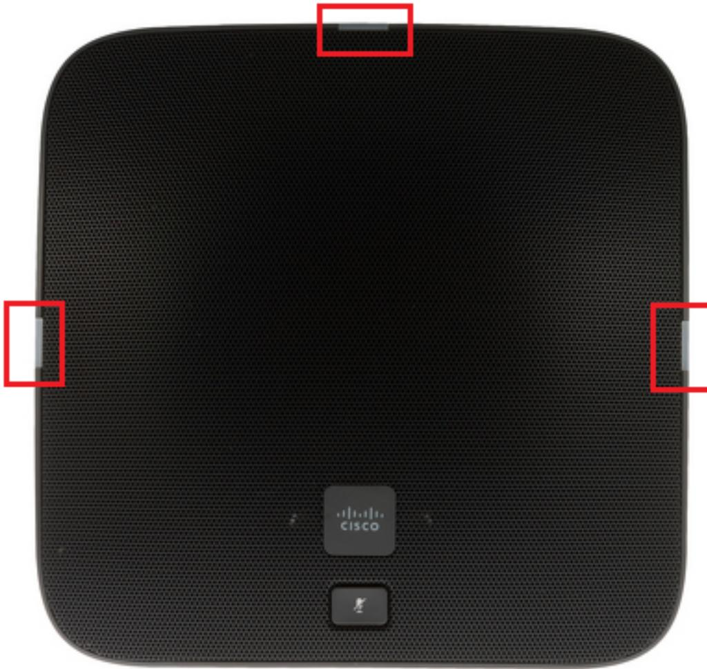
Schritt 4: Halten Sie die MIC-Taste etwa fünf Sekunden lang gedrückt, und lassen Sie sie dann wieder los. Die LEDs sollten zweimal rot blinken.
