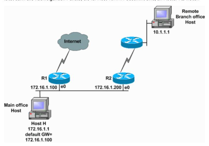
Diese Debugmeldung zeigt Router R1 wie im Netzwerkdiagramm an und sendet eine ICMP-Umleitungsmeldung an Host H (172.16.1.1).
