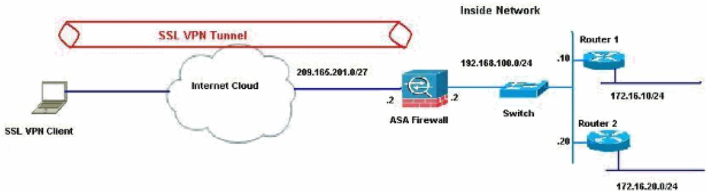
In diesem Beispiel greift der SSL VPN-Client über den Tunnel auf das interne Netzwerk der ASA zu. Der Datenverkehr für andere Ziele als das interne Netzwerk wird ebenfalls getunnelt, da kein Split-Tunnel konfiguriert ist, und wird über das TDG (192.168.100.20) geleitet.
