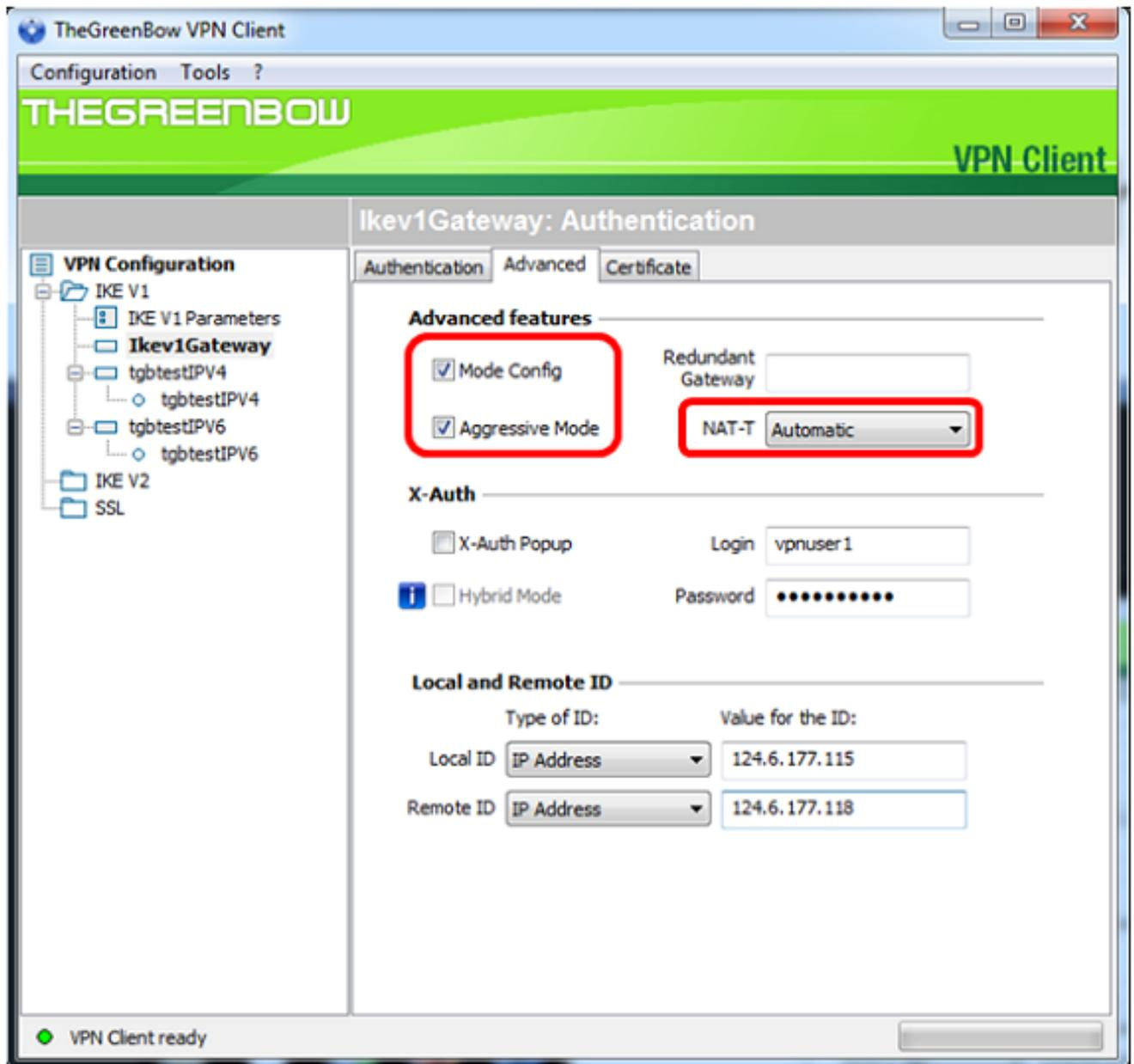
**Hinweis:** Bei aktivierter Moduskonfiguration ruft der GreenBow VPN Client Einstellungen vom VPN-Gateway ab, um einen Tunnel einzurichten und gleichzeitig den aggressiven Modus zu aktivieren. Mit NAT-T wird der Verbindungsaufbau beschleunigt.
