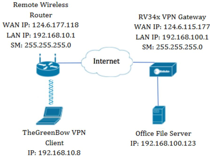
Im Diagramm stellt der Computer eine Verbindung zum Dateiserver im Büro außerhalb seines Netzwerks her, um auf seine Ressourcen zuzugreifen. Hierzu wird der GreenBow VPN Client im Computer so konfiguriert, dass er die Einstellungen vom RV34x VPN-Gateway abrufen.
