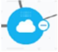
SNA kann feststellen, dass mehrere Geräte über einen bestimmten Port mit dem Netzwerk verbunden sind, kann jedoch die Beziehung zwischen diesen Geräten nicht abbilden. Dies liegt daran, dass keine SNA-fähigen Geräte vorhanden sind. SNA zeichnet eine Cloud auf der Topologieübersicht und zeigt die in dieser Cloud als verbundene Clients erkannten Geräte an.
