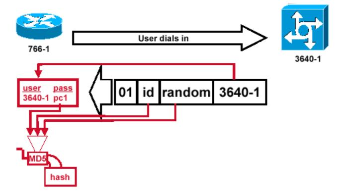
Abbildung 4 veranschaulicht, wie das Challenge-Paket vom Peer empfangen und verarbeitet wird (MD5). Der Router verarbeitet das eingehende CHAP-Challenge-Paket folgendermaßen:
