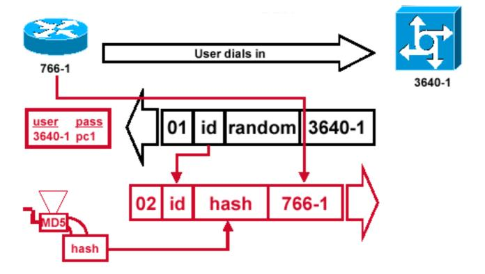
Abbildung 5 veranschaulicht, wie das an den Authentifizierer gesendete CHAP-Antwortpaket erstellt wird. Dieses Diagramm zeigt die folgenden Schritte:
