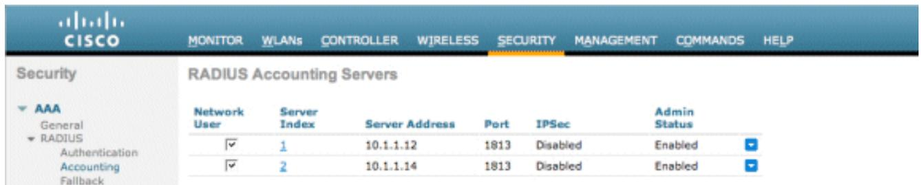
3. Ändern Sie das WLAN (Wireless-x), um den NAC Guest Server zu verwenden. Bearbeiten des WLAN (Wireless-x) Wählen Sie die Registerkarte **Sicherheit**. Ändern Sie die Layer-2-Sicherheit in **Keine** und die Layer-3-Sicherheit in die Verwendung der **Webauthentifizierung**.
