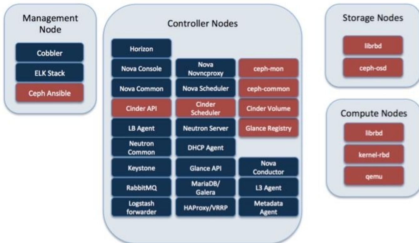
Ceph admite almacenamiento de objetos y bloques y, por lo tanto, se utiliza para almacenar imágenes y volúmenes de VM que se pueden conectar a VM. Entre los diversos servicios OpenStack que dependen del motor de almacenamiento se incluyen:
