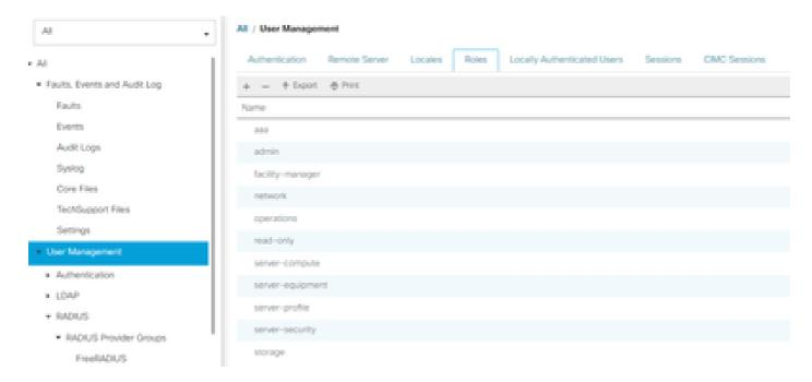
Si un usuario necesita tener varias funciones, se puede utilizar una coma entre las funciones y la sintaxis debe ser similar a cisco-avpair = "shell:roles=aaa,facility-manager,read-only". Si se define en el usuario una función que no se ha creado en UCSM, la autenticación en UCSM falla.
