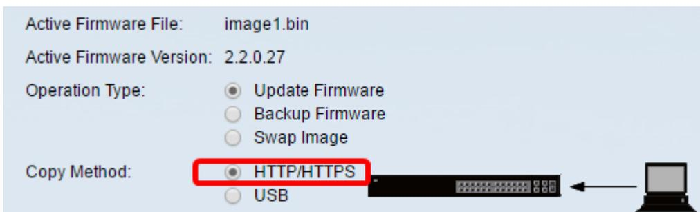
**Nota:** Elija **USB** si desea transferir firmware al switch mediante una unidad flash USB.
