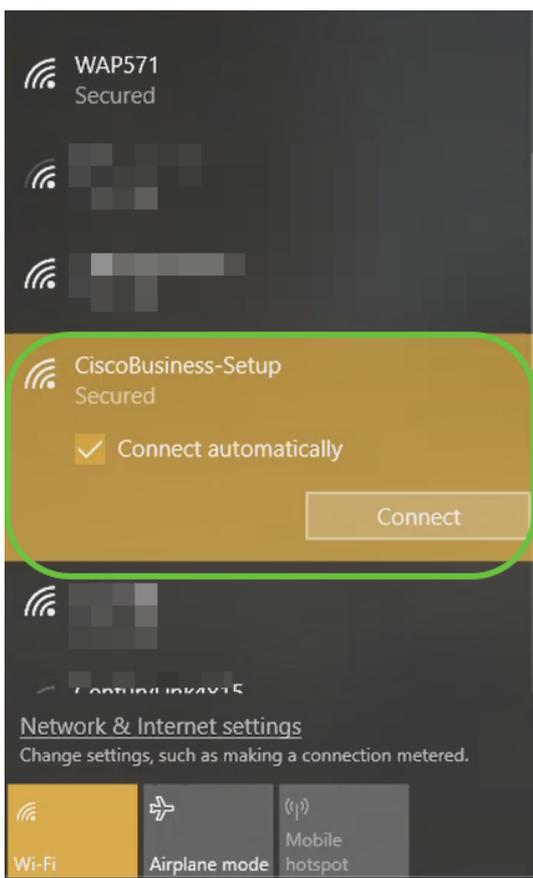
Si el punto de acceso no es nuevo, asegúrese de que se restablece a los parámetros predeterminados de fábrica para que el SSID *CiscoBusiness-Setup* aparezca en las opciones Wi-Fi.
