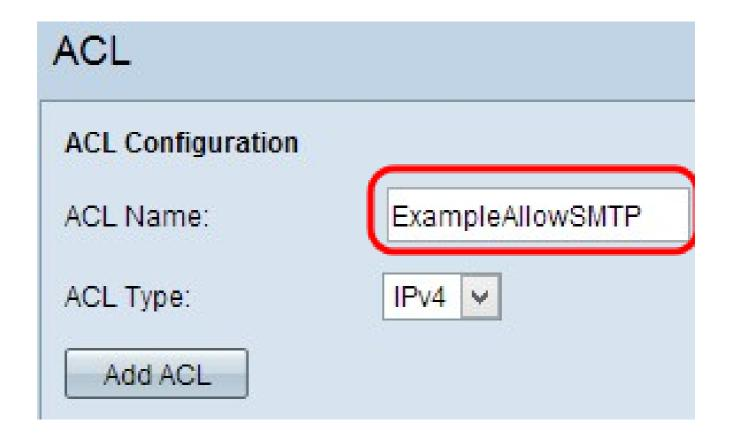
Paso 3. Elija el tipo IPv4 para la ACL en la lista desplegable Tipo de ACL.
