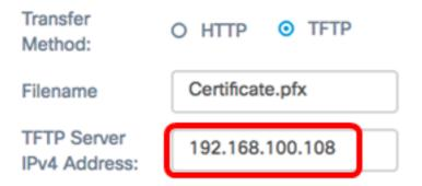
Nota: En este ejemplo. 192.168.100.108 se utiliza como dirección del servidor TFTP.
