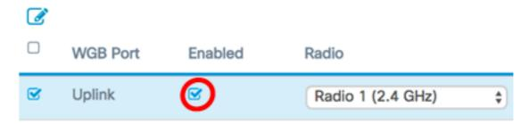
Paso 6. Elija la interfaz de radio para el puente de grupo de trabajo. Cuando se configura una radio como puente de grupo de trabajo, la otra permanece operativa. Las interfaces de radio corresponden a las bandas de radiofrecuencia del WAP. El WAP está equipado para transmitir en dos interfaces de radio diferentes. La configuración de la configuración de una interfaz de radio no afectará a la otra.
