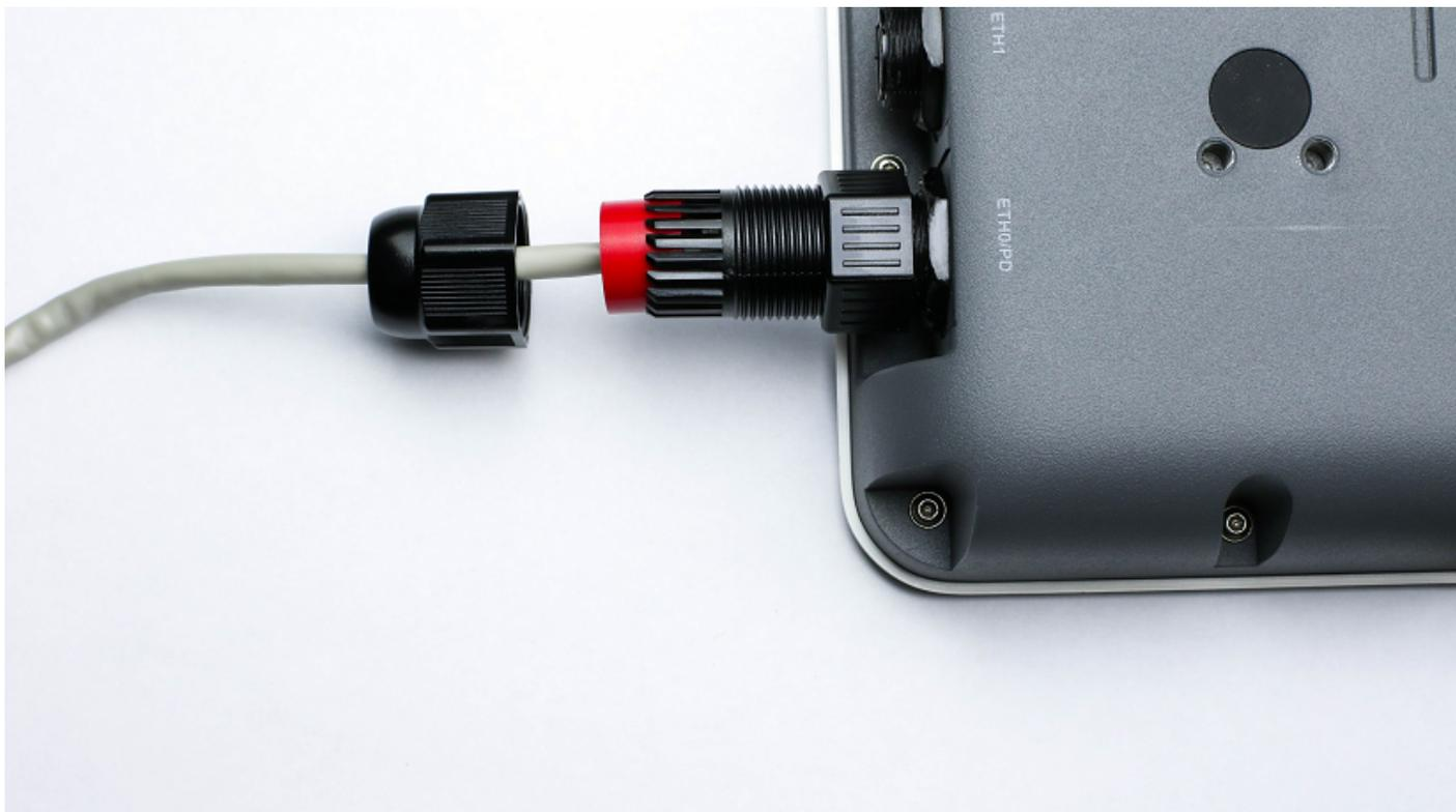
Paso 6. Inserte la junta de goma gruesa en la parte B del conector a prueba de tiempo.
