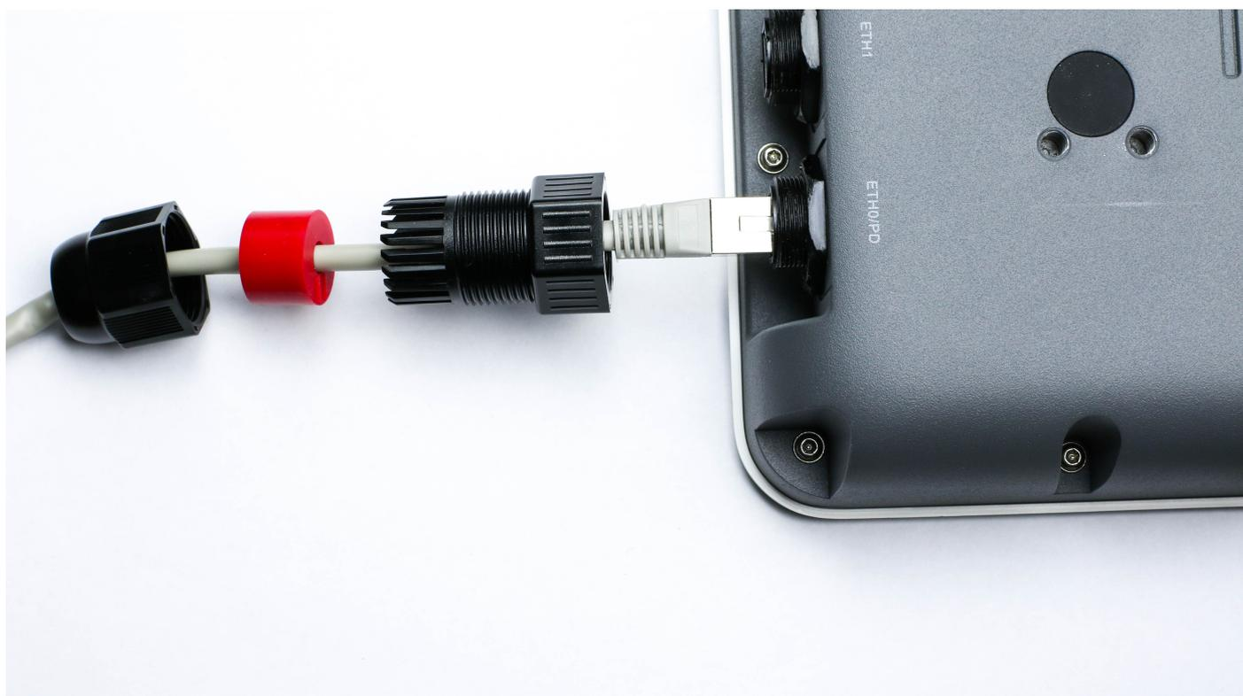
Paso 5. Fije el conector a prueba de tiempo girándolo en el sentido de las agujas del reloj a la parte roscada del WAP571E.
