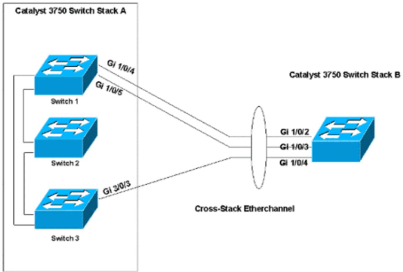
En este diagrama de red, hay dos pilas de switches Catalyst 3750, Stack A y Stack B. La pila A tiene tres miembros de switch y la pila B sólo tiene un miembro de switch. El EtherChannel se forma con dos puertos en el Switch1 y un puerto en el switch 3 del stack A. Estos puertos conectan con los tres puertos en el stack B.
