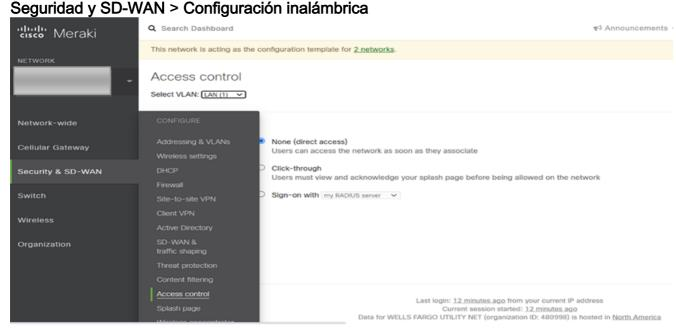
2. Puntos de acceso MR (activados por identificador de conjunto de servicios (SSID)): Wireless > Access control
