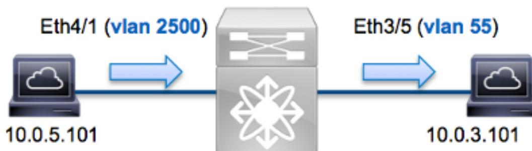
En este ejemplo, un host en el VLA N 2500 (10.0.5.101), el puerto **Eth4/1** envía una petición del Internet Control Message Protocol (ICMP) a un host en el VLA N 55 (10.0.3.101), vira **Eth3/5 hacia el lado de babor**. ELAM se utiliza para capturar este solo paquete de 10.0.5.101 a 10.0.3.101. Es importante recordar que ELAM permite que usted capture una sola trama.
