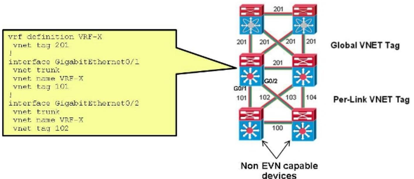
Avec cette configuration, l'étiquette VNET utilisée sur la ligne principale entre CORE-1 et CORE-2 pour CUST-A passe de 100 à 101 :
