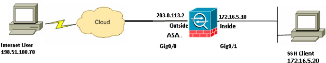
Dans cet exemple de configuration, l'ASA est considéré comme le serveur SSH. Le trafic des clients SSH (198.51.100.70/32 et 172.16.5.20/24) vers le serveur SSH est chiffré. L'apppliance de sécurité prend en charge la fonctionnalité SSH remote shell fournie dans SSH versions 1 et 2 et prend en charge les chiffrement DES (Data Encryption Standard) et 3DES. Les versions SSH 1 et 2 sont différentes et ne sont pas interopérables.
