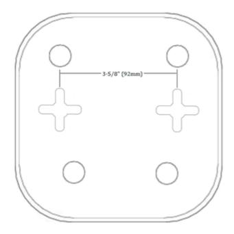
Étape 3. Insérez un tox (1-2) dans chaque trou, laissant un espace entre la surface et la base de la tête de tox. Voici les dimensions :
