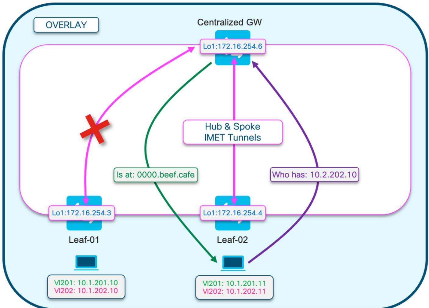
Ce schéma permet de visualiser le flux du processus de résolution ARP décrit dans cette section.
