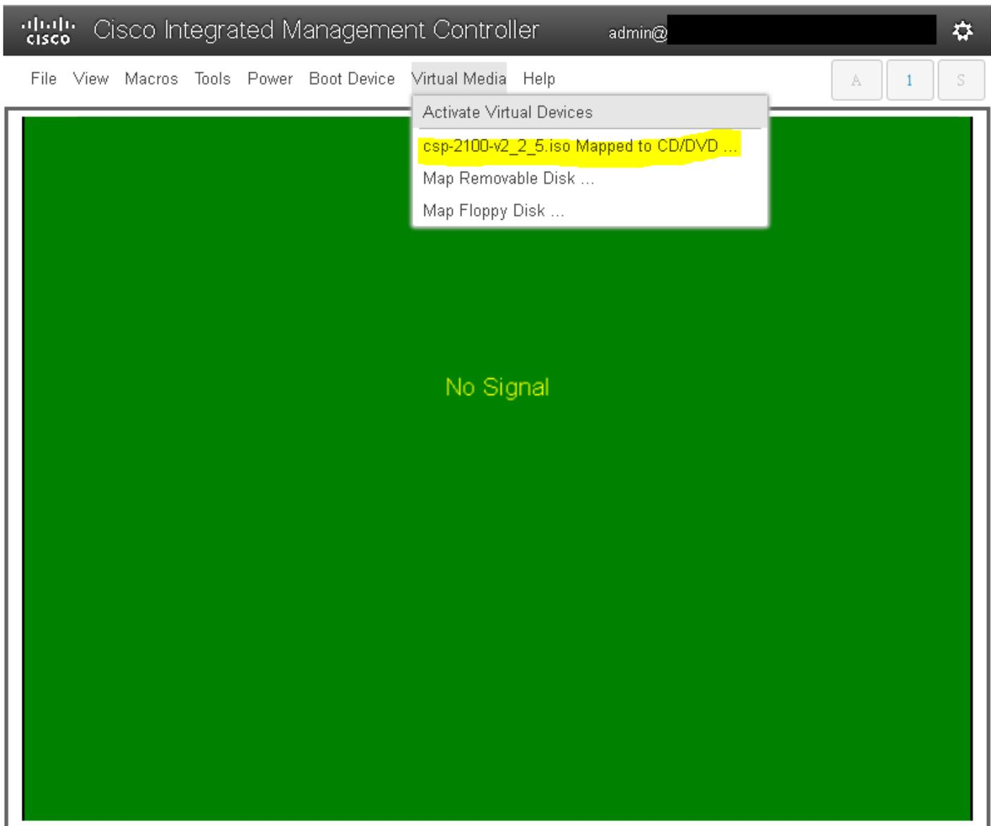
ÉTAPE 6. Mettez le serveur sous tension (redémarrage à froid) et appuyez sur F6 pour entrer dans « Menu de sélection de démarrage » et sélectionnez « Cisco vKVM-Mapped vDVD1.22 »
