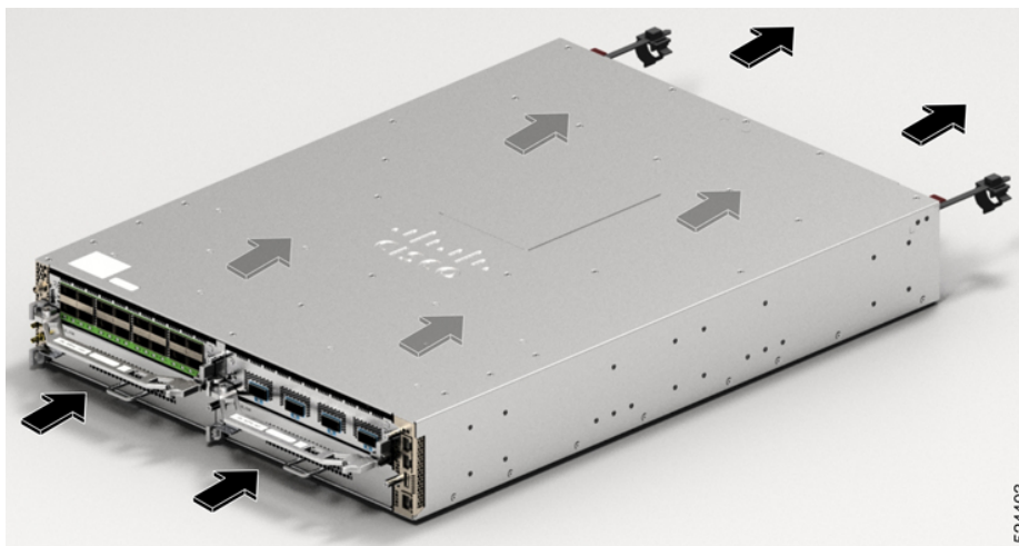
Illustration 5 : Direction de la circulation d'air pour le routeur Cisco 8712-MOD-M dans la configuration d'entrée d'air du côté des ports
