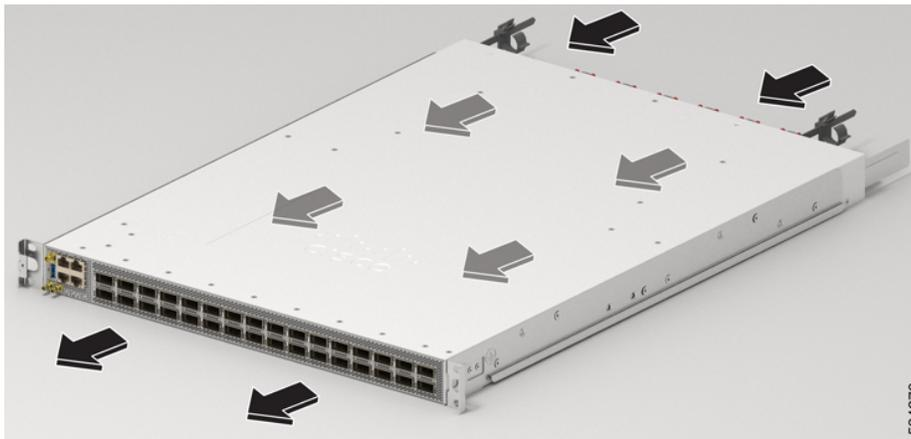
**Illustration 5 : Direction de la circulation d'air pour le routeur Cisco 8712-MOD-M dans la configuration d'entrée d'air du côté des ports**
