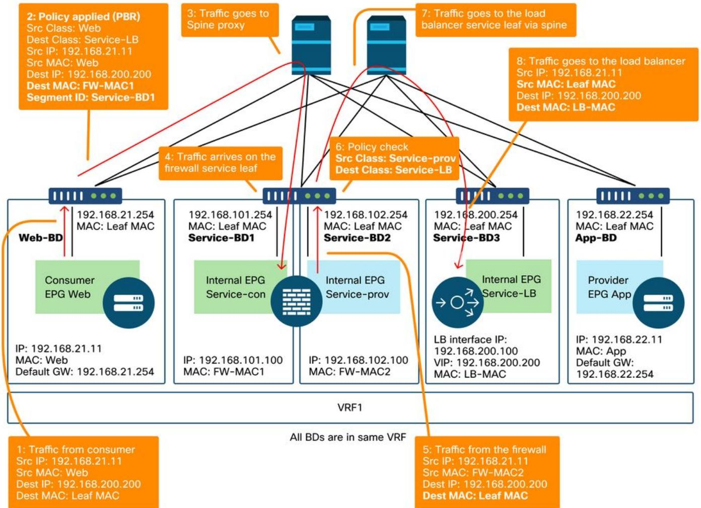
**Esempio di percorso di inoltro del firewall e del bilanciamento del carico senza SNAT - da consumer a VIP e da bilanciamento del carico a provider (continua)**
