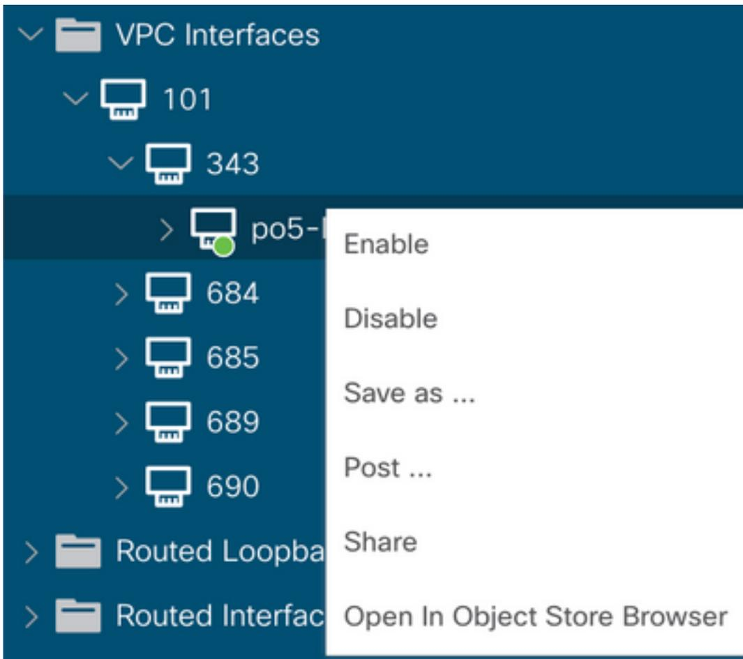
Queste operazioni devono essere eseguite sull'interfaccia interessata per forzare la sincronizzazione del canale della porta con il dispositivo peer e, dopo questo processo, devono funzionare correttamente.
