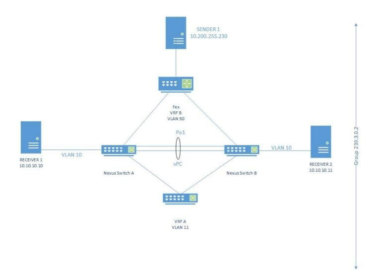
Il traffico multicast viene inoltrato a un solo ricevitore nella vlan10 collegata al peer vpc primario, mentre il ricevitore collegato al peer secondario non lo riceve.
