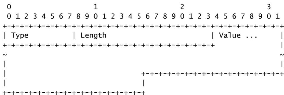
Il TLV Stato MP LDP può essere visualizzato in un messaggio di mappatura etichette o in un messaggio di notifica LDP.
