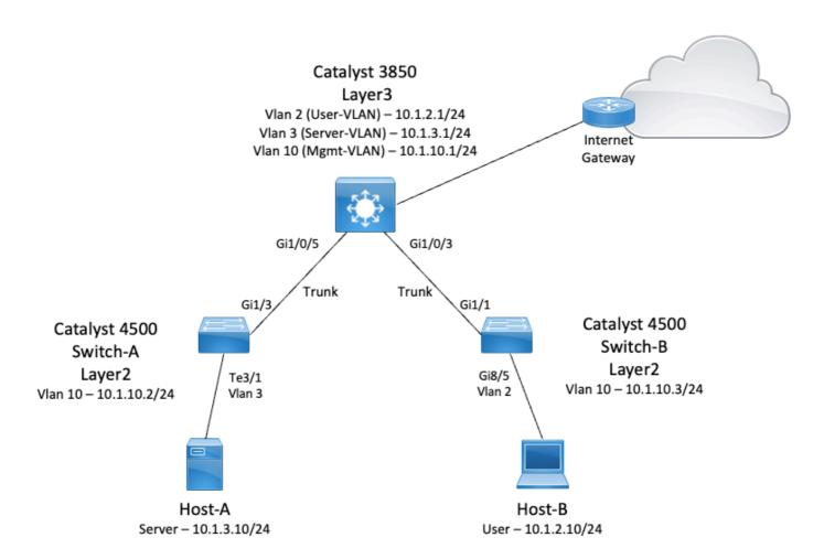
In questo diagramma, lo switch Catalyst 3850 fornisce la funzione di routing tra VLAN tra le diverse VLAN. Il dispositivo Catalyst 3850 Switch può agire come dispositivo L2 disabilitando il routing IP. Affinché lo switch funzioni come dispositivo L3 e fornisca il routing tra VLAN, verificare che il routing IP sia abilitato a livello globale.
