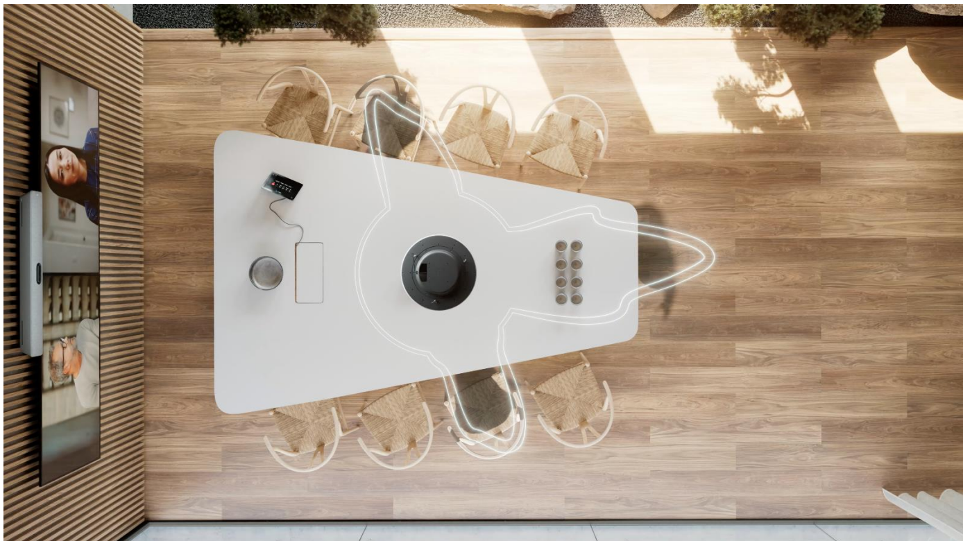
図 5. 適応型ビームは、中規模会議室で室内参加者の声をトラッキングしてキャプチャします。
