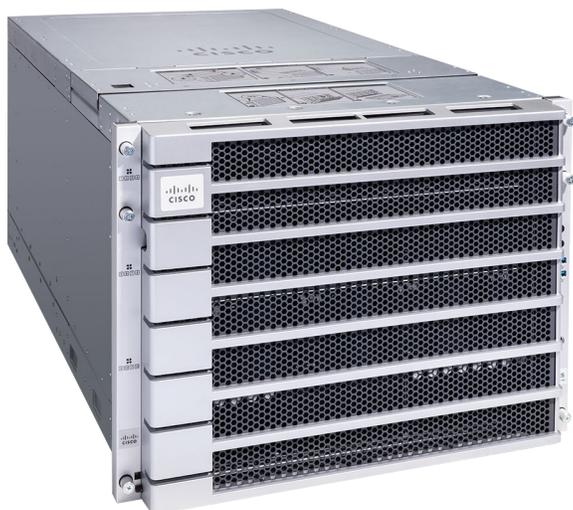
このサーバは、8 個の NVIDIA HGX H100 または H200 Tensor コア GPU、または 8 個の AMD MI300X OAM GPU を選択して、単一のサーバで大規模で高速化された計算パフォーマンスを提供します。また、GPU ごとに 1 個の NVIDIA ConnectX-7 NIC または NVIDIA BlueField-3 SuperNIC も搭載し、高密度の GPU サーバのクラスタ全体で AI モデルのトレーニングを拡張することが可能です。
