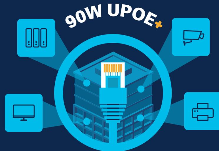
Cisco® Catalyst® 9000 スイッチなどのソリューションでは、90W の Universal Power Over Ethernet (UPOE+) を利用できます。銅線のイーサネットケーブルを介して DC 電力をデバイスに供給できるため、専用の電源やコンセントは必要ありません。
