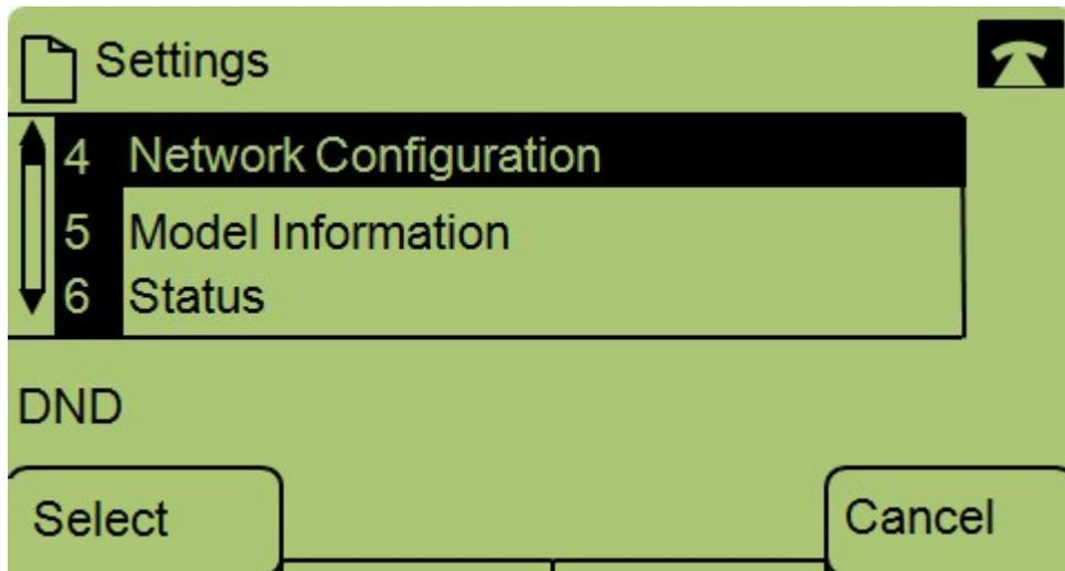
ステップ3：キーパッドで4を押すか、[Network Configuration]に移動します。
