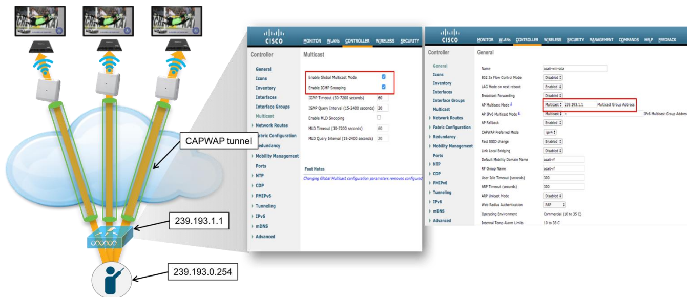
図 40 : マルチキャスト用 Wi-Fi ネットワークの設定の概要
