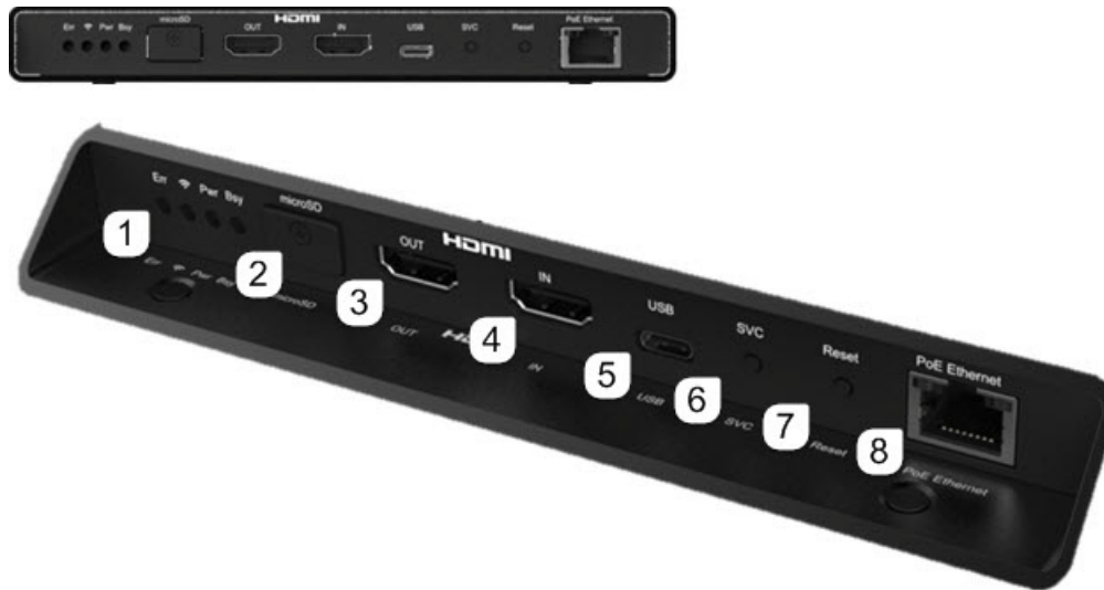
図 12 CV-UHD の前面パネル
