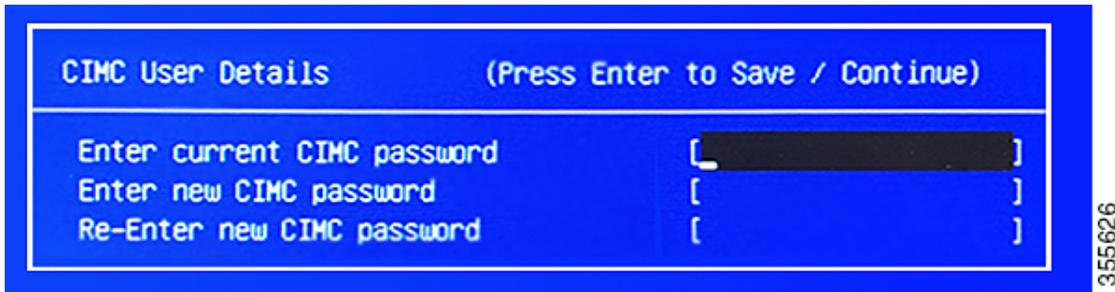
ステップ5 デフォルトの CIMC ユーザパスワード（新規アプライアンスで付与されるデフォルトのパスワードは「password」）を [Enter current CIMC Password] フィールドに入力します。
