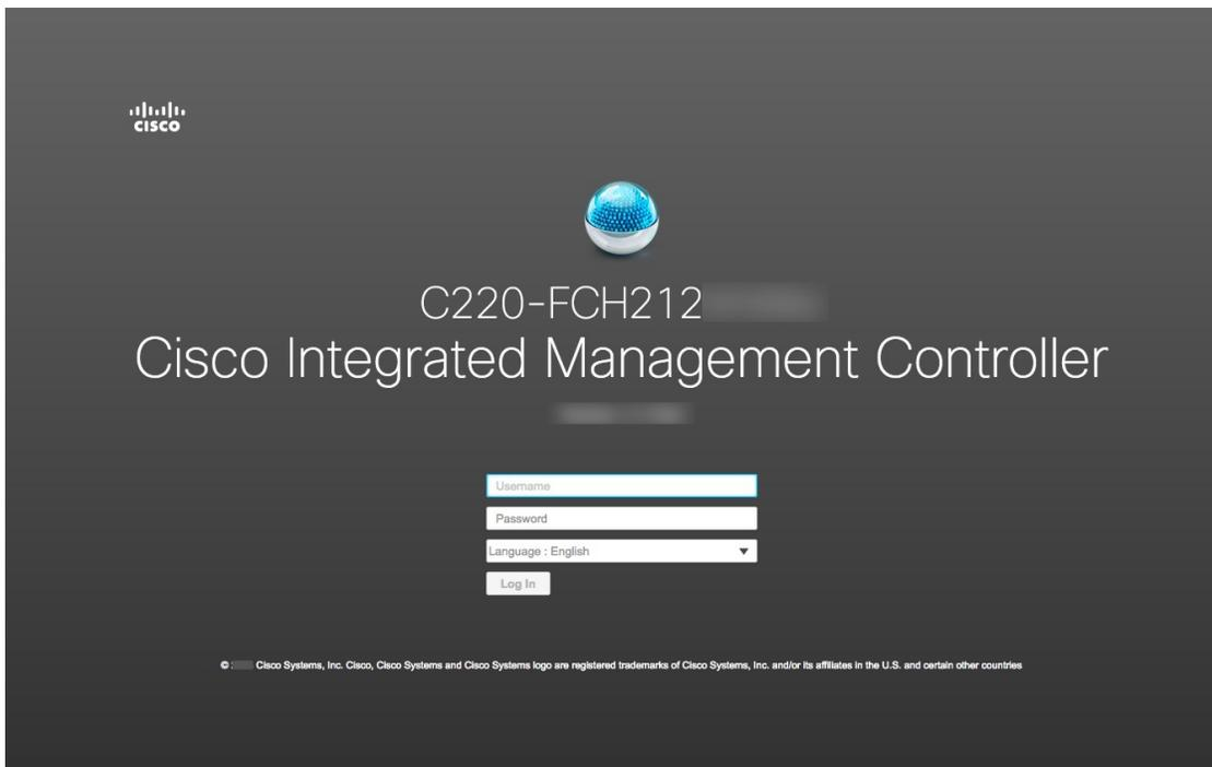
**ステップ 13** ステップ 5 で設定した Cisco IMC ユーザのユーザ ID とパスワードを使用してログインします。
