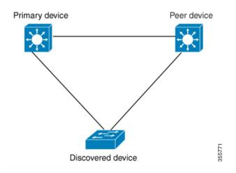
Cisco DNA Center プライマリ デバイスで DHCP サーバーを設定します。Cisco DNA Center が検 出されたデバイスがプライマリ デバイスとピア デバイスの両方に接続されていることを理解 しているため、LAN 自動化タスクが停止されると、2つのレイヤー3ポイントツーポイント接 続を設定します。1つの接続は、検出されたデバイスとプライマリデバイスの間で確立されます。もう 1 つの接続は検出されたデバイスとピア デバイスの間で確立されます。
