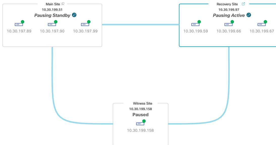
**CatalystCenter** で必要なタスクが完了すると、トポロジに表示されたメインサイト、リカバリサイト、および監視サイトのステータスが更新されて **[Paused]** に設定されます。
