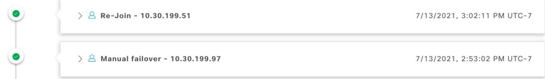
たとえば、システムの一時停止後の復元についてモニターするとします。この場合、復元プロセスの各タスクが開始されたときと完了したときに、Catalyst Center でイベントのタイムラインが更新されます。特定のタスクにおける処理の概要を表示するには、[>] をクリックします。
