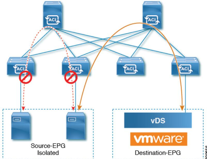
ベアメタルの EPG 分離はリーフスイッチで適用されます。ベアメタルサーバは VLAN カプセル化を使用します。ユニキャスト、マルチキャスト、およびブロードキャストのすべてのトラフィックが、分離が適用された EPG 内でドロップ（拒否）されます。ACI ブリッジドメインには、分離された EPG と通常の EPG を混在させることができます。分離された EPG それぞれには、VLAN 間トラフィックを拒否する複数の VLAN を指定できます。
