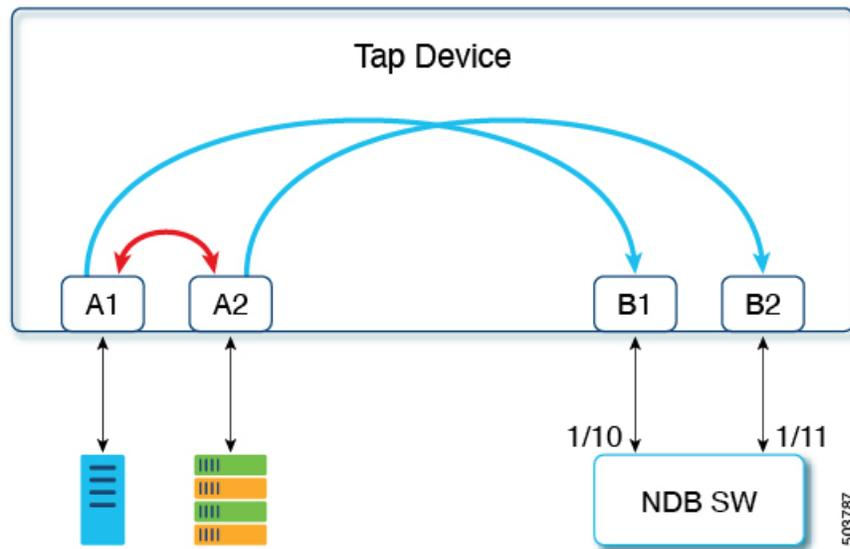
**Cisco Nexus Dashboard Data Broker** で **Cisco Nexus 3550-F L1** スイッチをタップデバイスとして使用する利点
