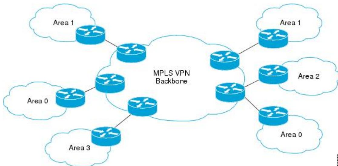
OSPF を使用して PE デバイスと CE デバイスを接続するには、VPN サイトから学習したすべてのルーティング情報を、着信インターフェイスに関連付けられた VPN ルーティングおよび転送 (VRF) インスタンスに格納します。VPN に接続された PE デバイス間では、ボーダークラウドプロトコル (BGP) を使用して、VPN ルートが交換されます。CE デバイスはこの VPN 内の他のサイトへのルートを、自分が接続された PE デバイスとのピアリングによって学習します。MPLS VPN スーパーバックボーンは、OSPF を実行する各 VPN サイトを内部接続するための追加のルーティング階層レベルを提供します。
