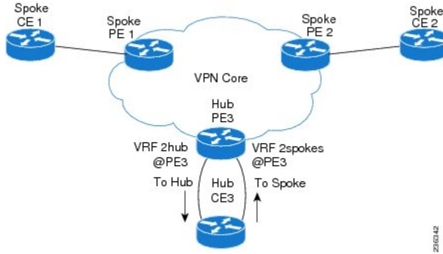
図に示すように、ハブアンドスポーク トポロジは通常、2つの VRF で設定されたハブ PE で設定されます。
