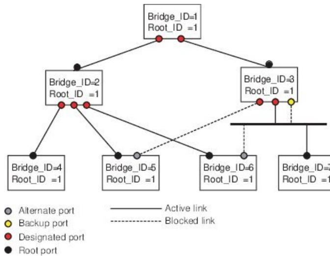
次の図はポートロールを示しています。ルートポートまたは指定ポートのロールを持つポートは、アクティブなトポロジに含まれます。代替ポートまたはバックアップポートのロールがあるポートは、アクティブトポロジから除外されます。
